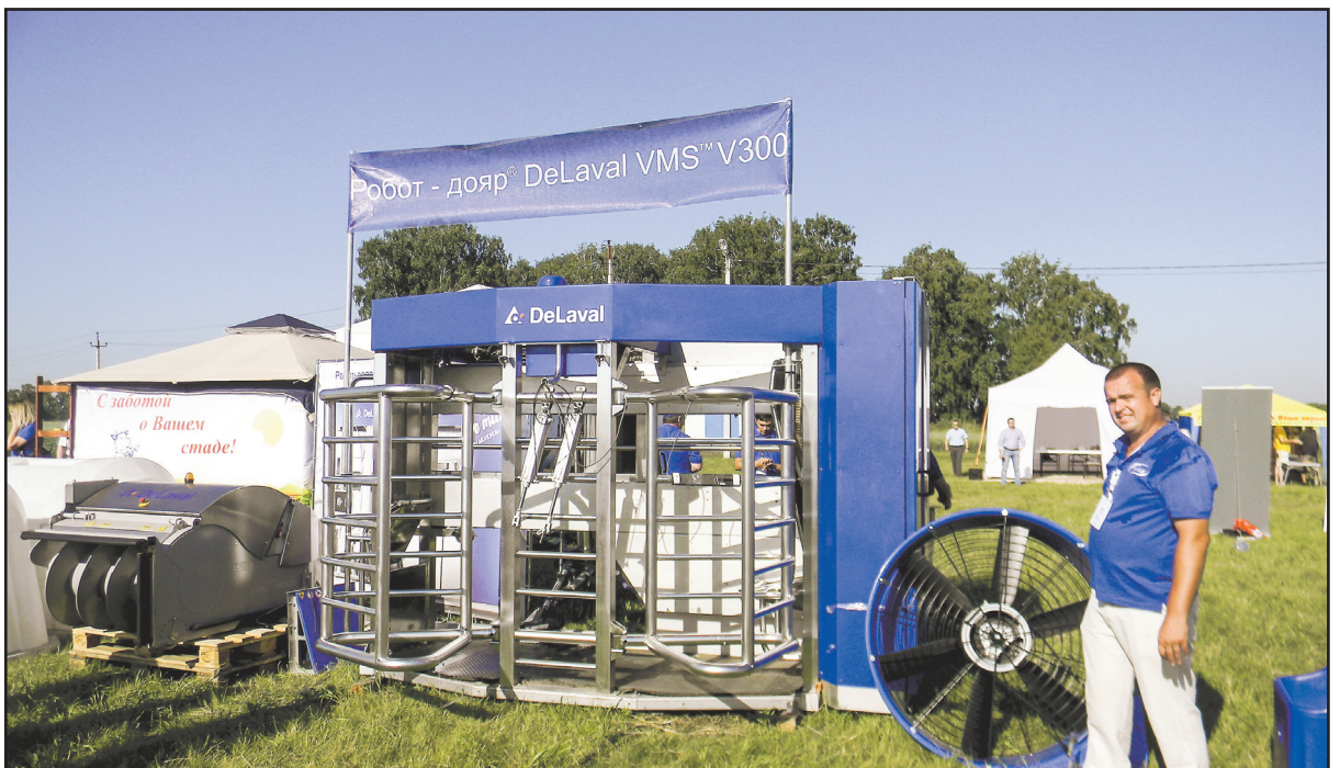
Такой робот-дойяр может «обслуживать» до 80 коров в сутки
