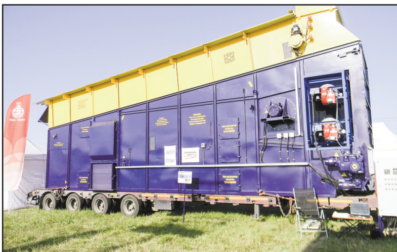
Зерноочистительная машина российского производства поможет крестьянам заготовить и сохранить зерно более высокого качества
